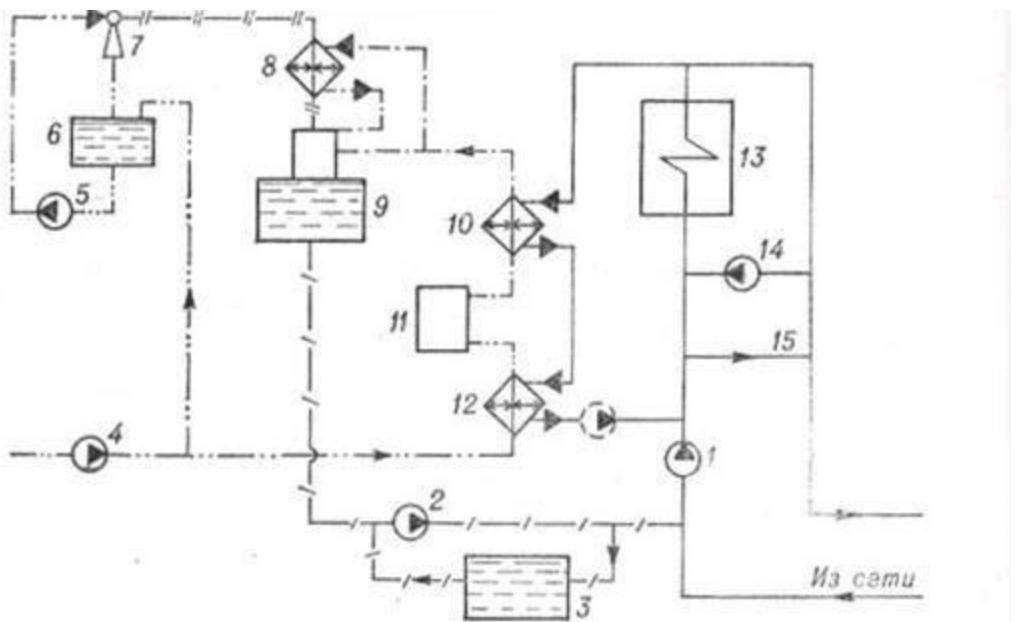
1—сетевой насос; 2—подпиточный насос; 3—бак подпиточной воды; 4—насос исходной воды; 5—насос подачи воды к эжектору; 6—расходный бак эжекторной установки; 7—водоструйный эжектор; 8—охладитель выпара; 9—вакуумный деаэратор; 10—подогреватель химически очищенной воды; 11—фильтр химводоочистки; 12—подогреватель исходной воды; 13—водогрейный котел; 14—рециркуляционный насос; 15—линия перепуска.
