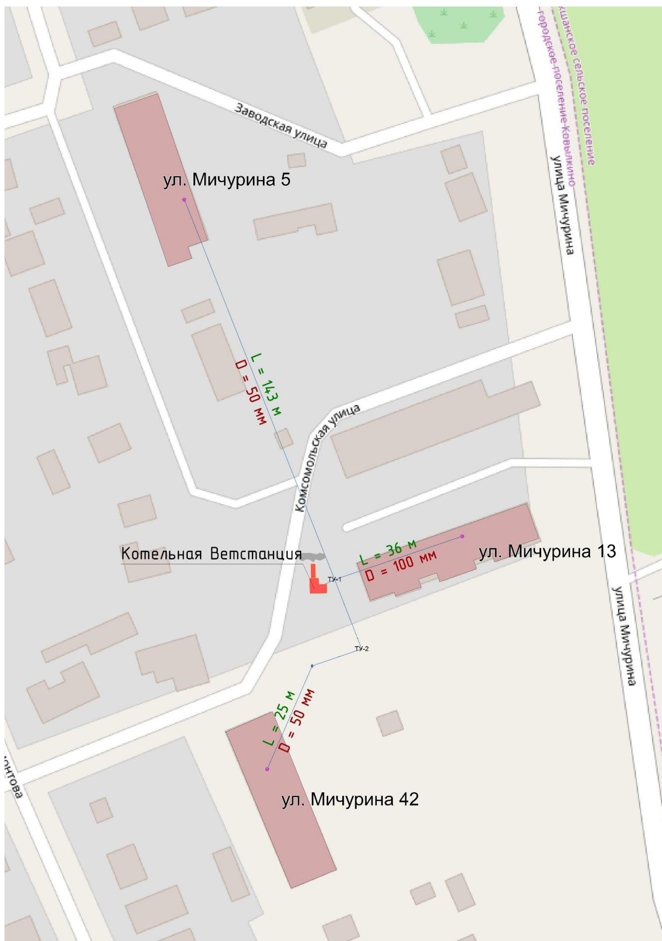
Рисунок 1.8 - Зона действия котельной Ветстанции Новая
