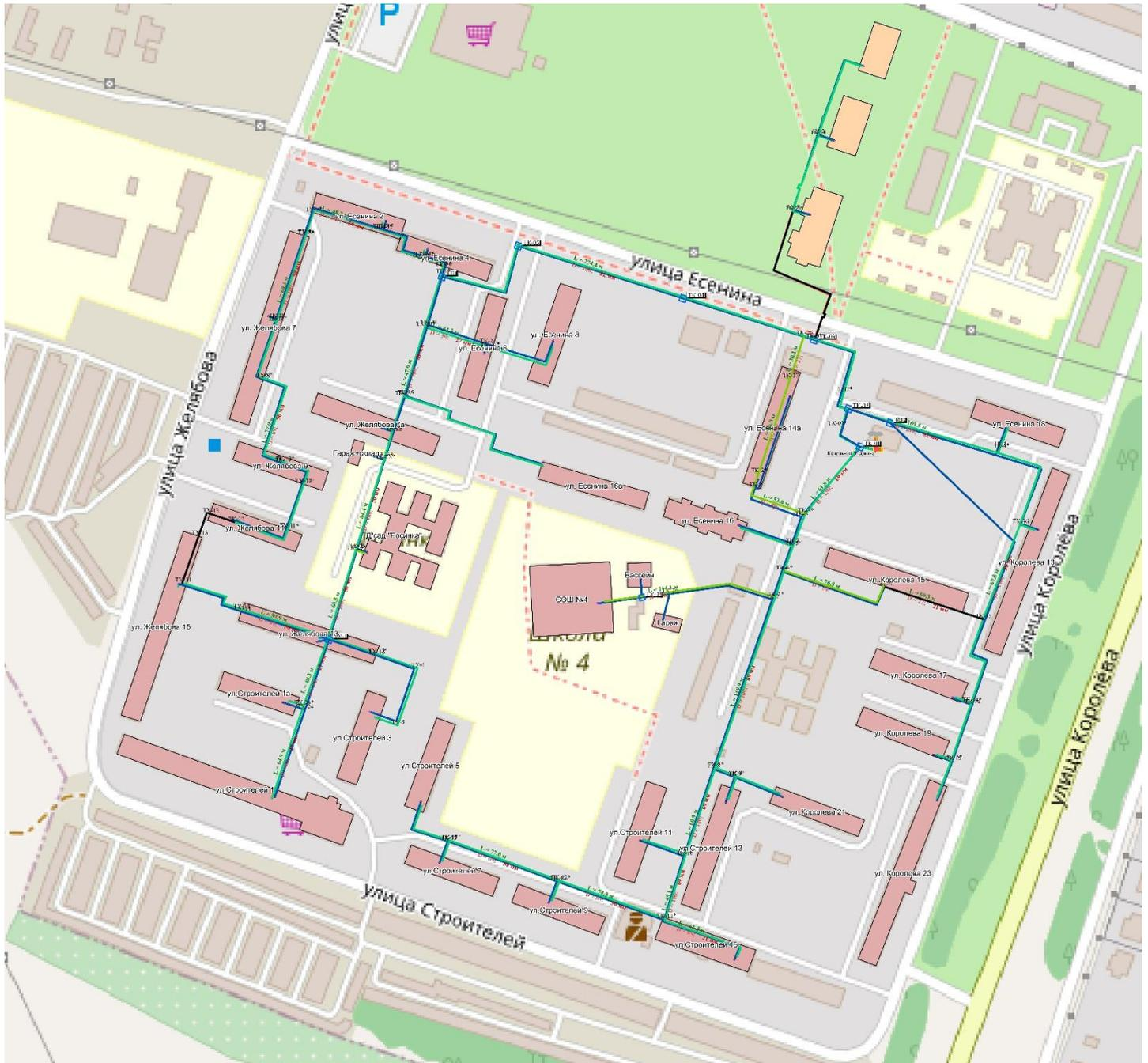
Схема 6. - Зона действия котельной 18 МВт (Есенина)
